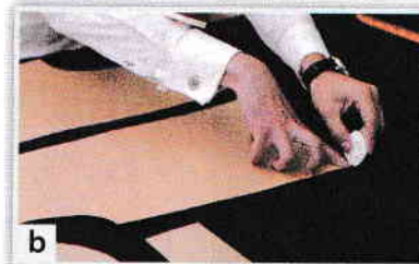
Fig. 15. Operații de pregătire: a – călcarea; b – șablonarea
